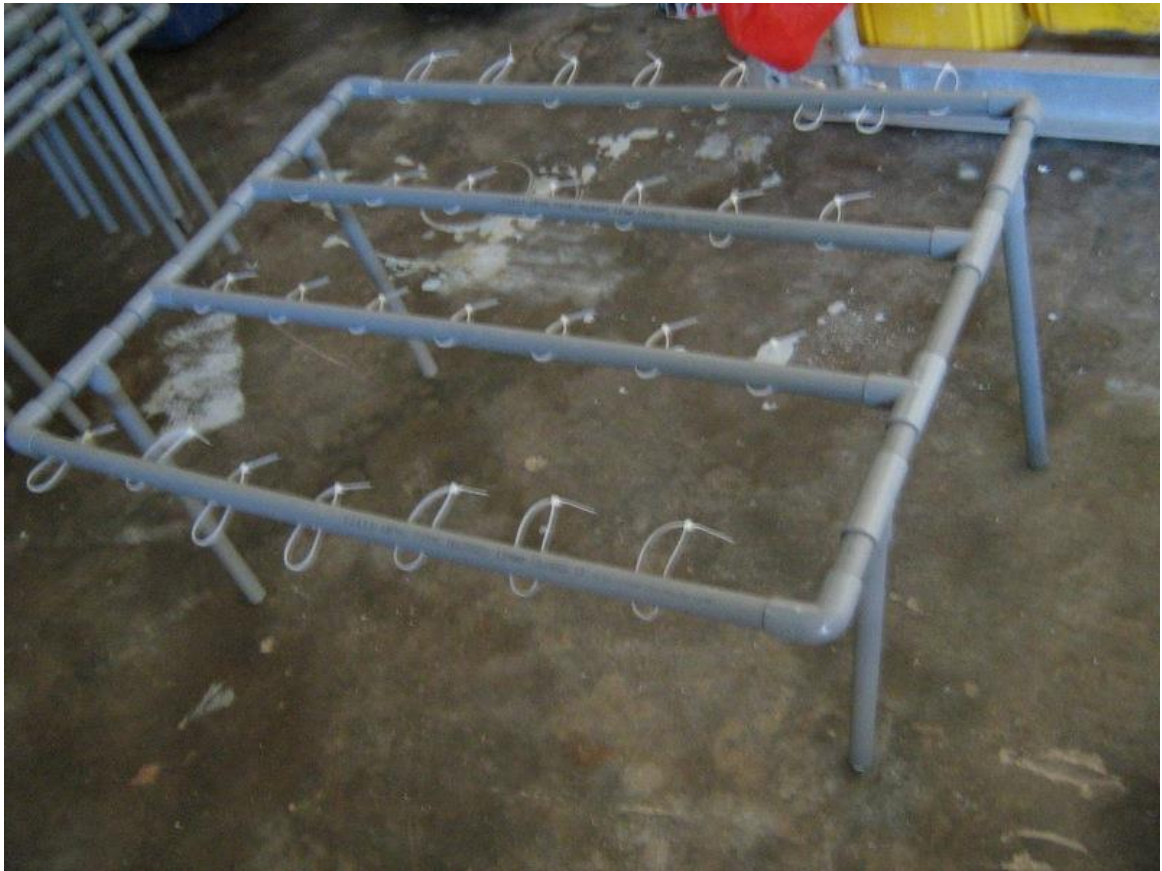
Rajah 3.4 Gambaran seunit struktur rangka PVC yang digunakan untuk penyemaian karang di tapak Tekek dan tapak Air Batang.
